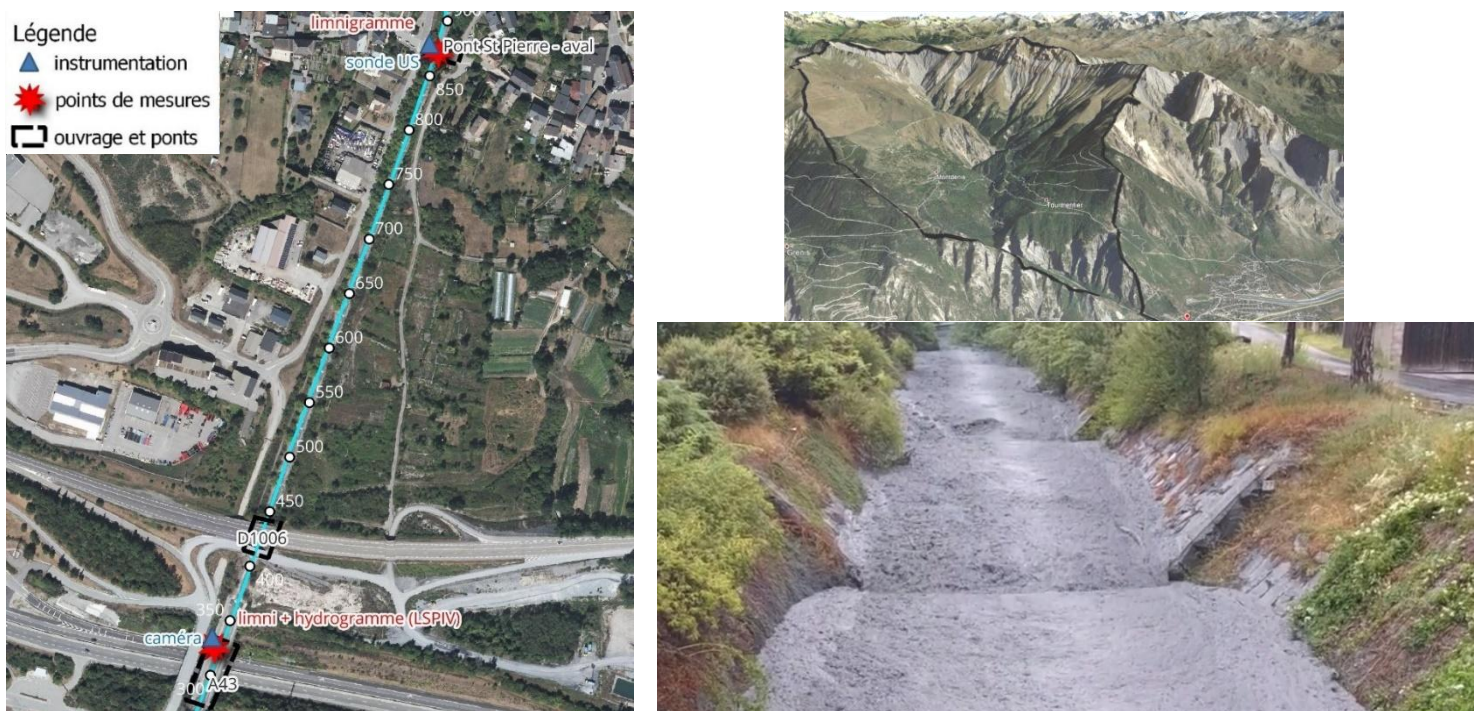
Figure 1 : Disposition des points de mesures le long du canal (gauche), bassin versant du torrent du Saint Julien (droite haut – source Google Earth), écoulement de la lave torrentielle dans le canal lors de l'évènement de juillet 2017 (droite bas).
