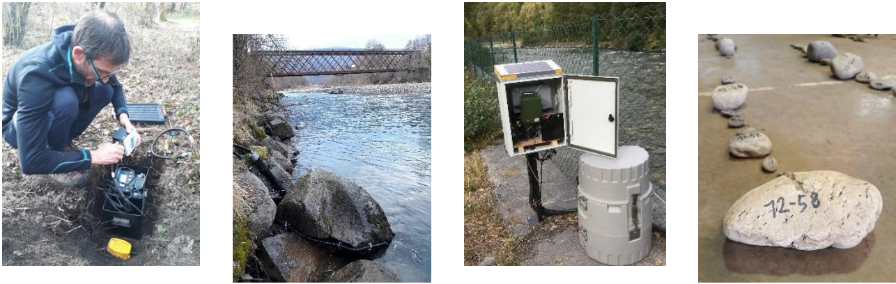
Figure 1 - Exemples d'outils de mesure du transport solide déployés dans le cadre du projet O2H (de gauche à droite : géophone ; hydrophone ; préleveur automatique de MES ; traceurs RFID)
