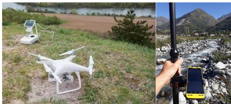
Figure 2 - Outils d'observation des cours d'eau « légers » (de gauche à droite : drone ; antenne GNSS et terminal de saisie)
