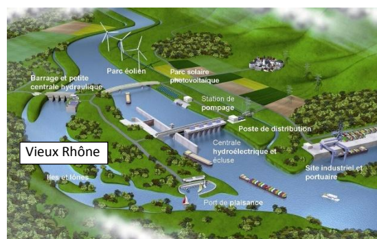
Figure 2 : chute CNR type construite entre 1939 et 1987
